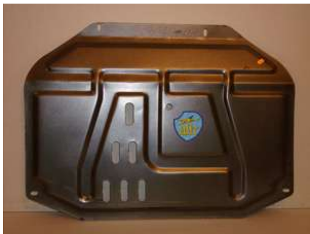
Рис. 11. Типовая штампованная защита картера.
